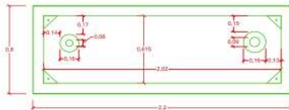
VISTA EN PLANTA ESTRUCTURA EDR
