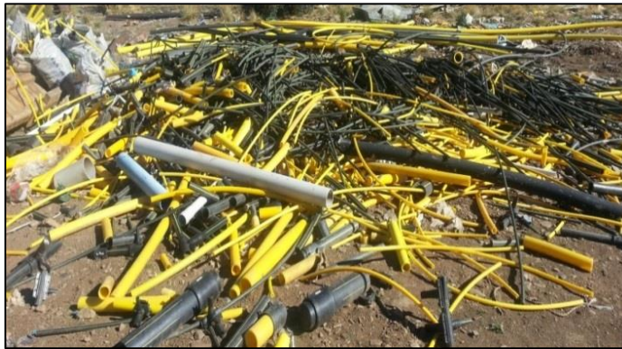
Restos de Tubería de polietileno
