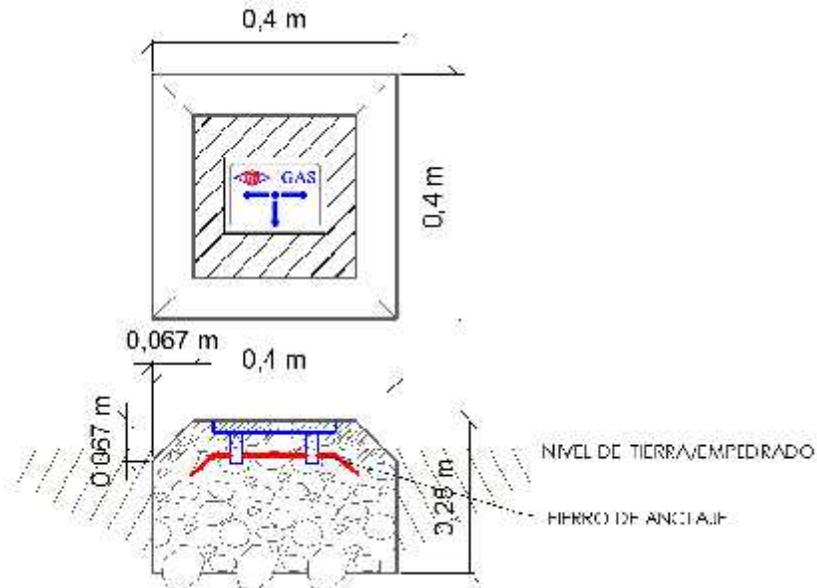
**LOSETAS DE SEÑALIZACIÓN HORIZONTAL EN COBERTURAS DE HORMIGÓN.**
