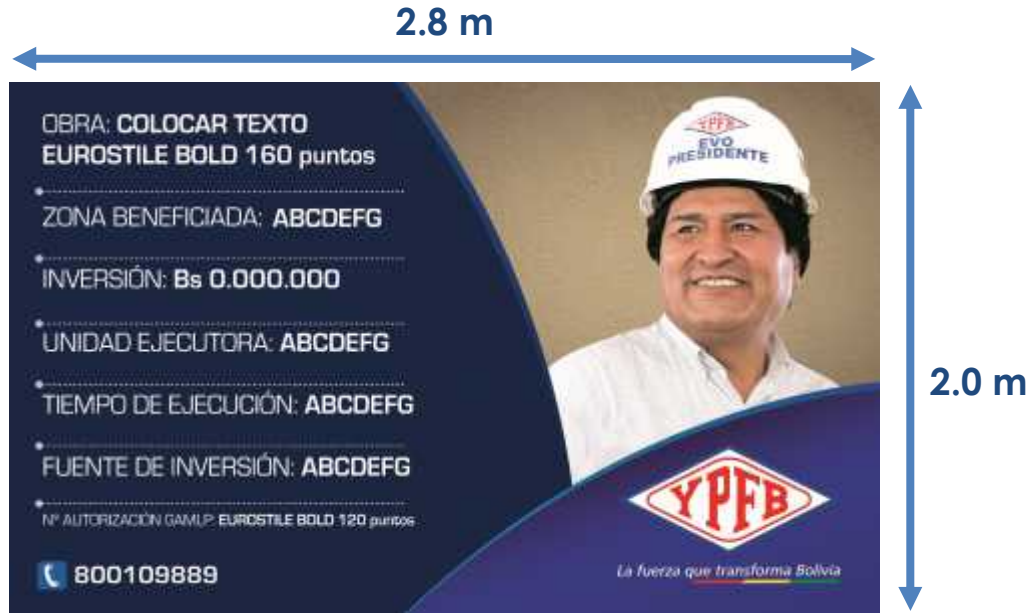
FIGURA 1. LETRERO DE OBRA
