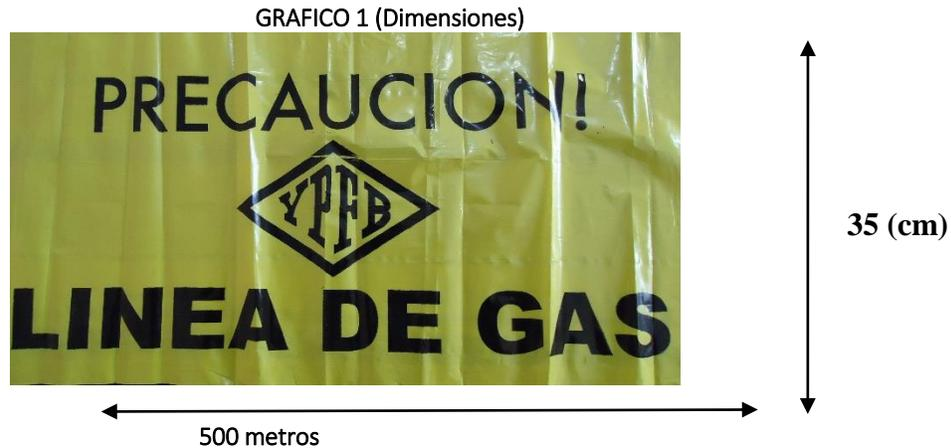
La cinta de señalización debe ser ubicada 30 cm sobre el nivel superior de la tubería de PE indicando “PRECAUCIÓN – LÍNEA DE GAS”
