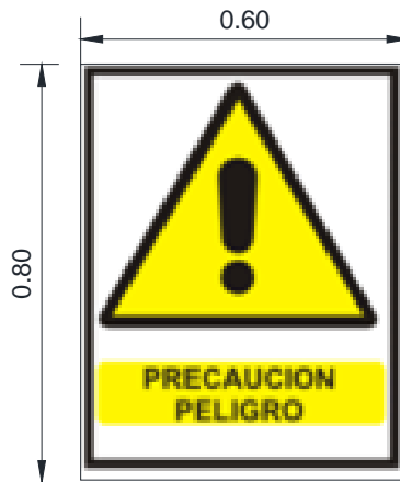
Figura 1. Señales de Advertencia
