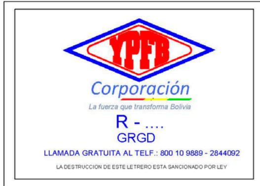
MATERIAL: PLANCHA DE 0.7 MM LONGITUD: 0.7 METROS ANCHO: 0.5 METROS
