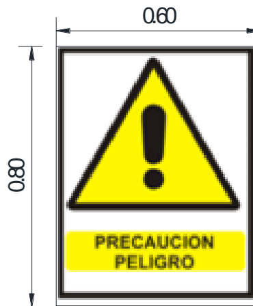
Figura 1. Señales de Advertencia
