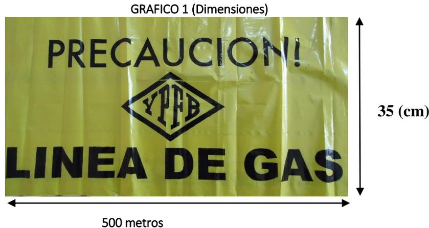
La cinta de señalización debe ser ubicada 30 cm sobre el nivel superior de la tubería de PE indicando “PRECAUCIÓN – LÍNEA DE GAS”
