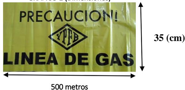
La cinta de señalización debe ser ubicada 30 cm sobre el nivel superior de la tubería de PE indicando "PRECAUCIÓN – LÍNEA DE GAS"
