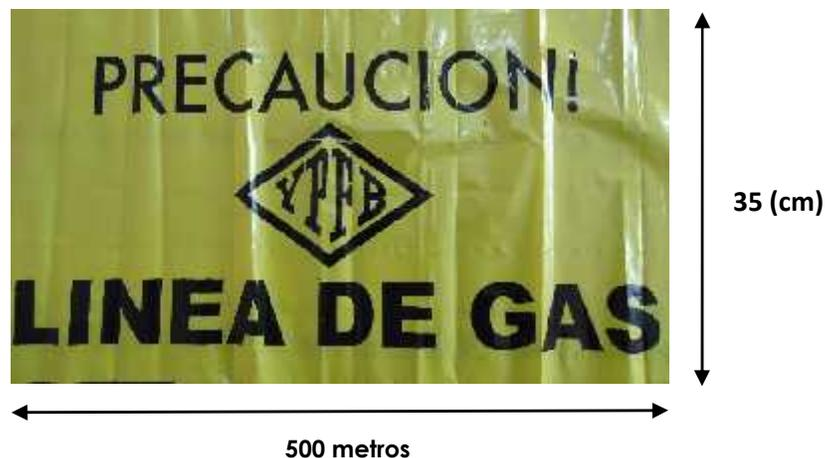
La cinta de señalización debe ser ubicada 30 cm antes del nivel superior de la zanja indicando
