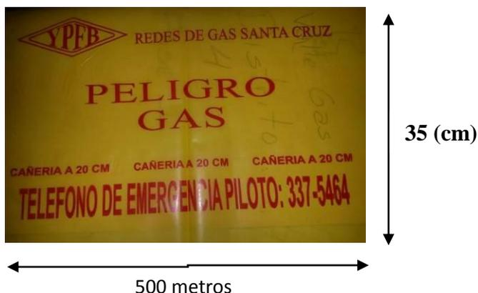
La cinta de señalización debe ser ubicada 30 cm antes del nivel superior de la zanja indicando "PELIGRO GAS".
