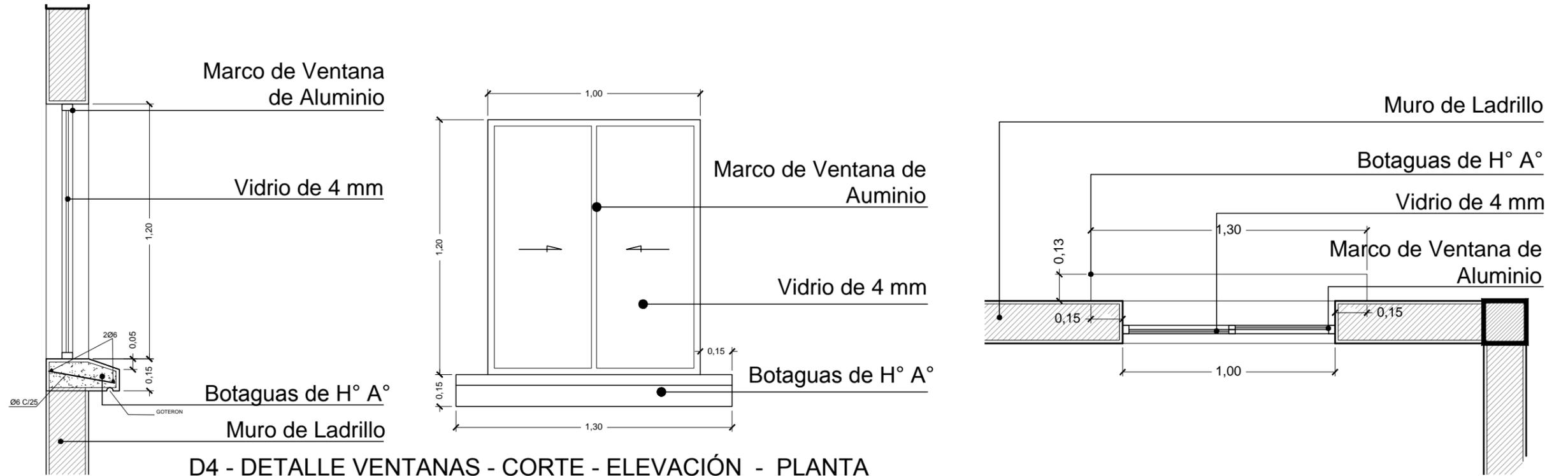
D4 - DETALLE VENTANAS - CORTE - ELEVACIÓN - PLANTA
