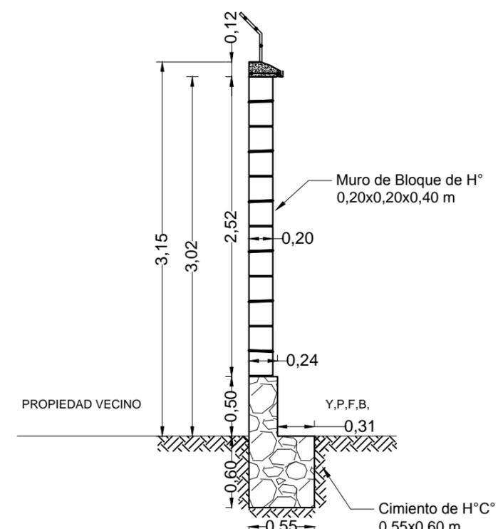
**CORTE MURO DE BLOQUES DE HORMIGÓN COINDANTE VECINO**
