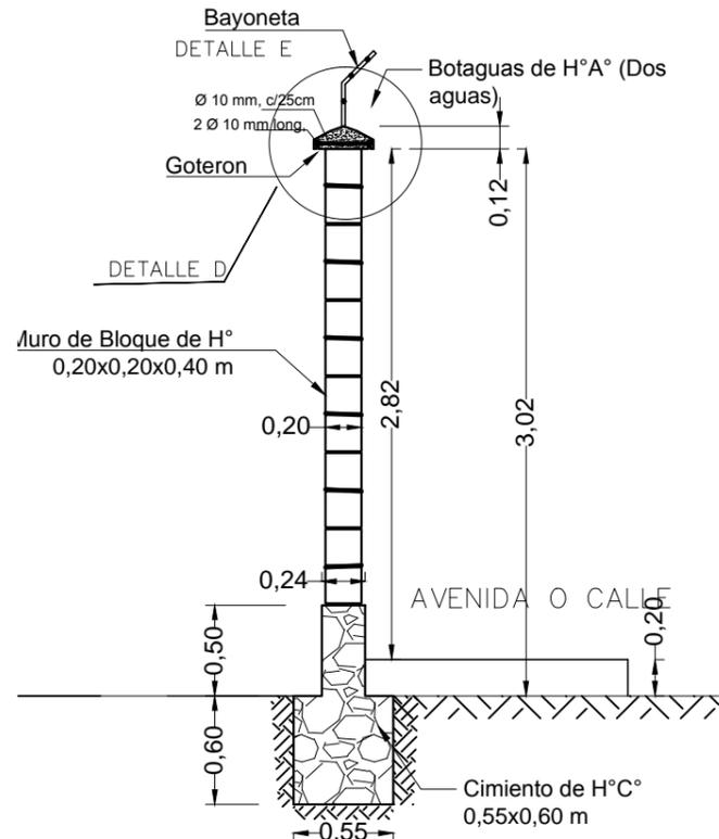
**CORTE MURO DE BLOQUES DE HORMIGÓN**
