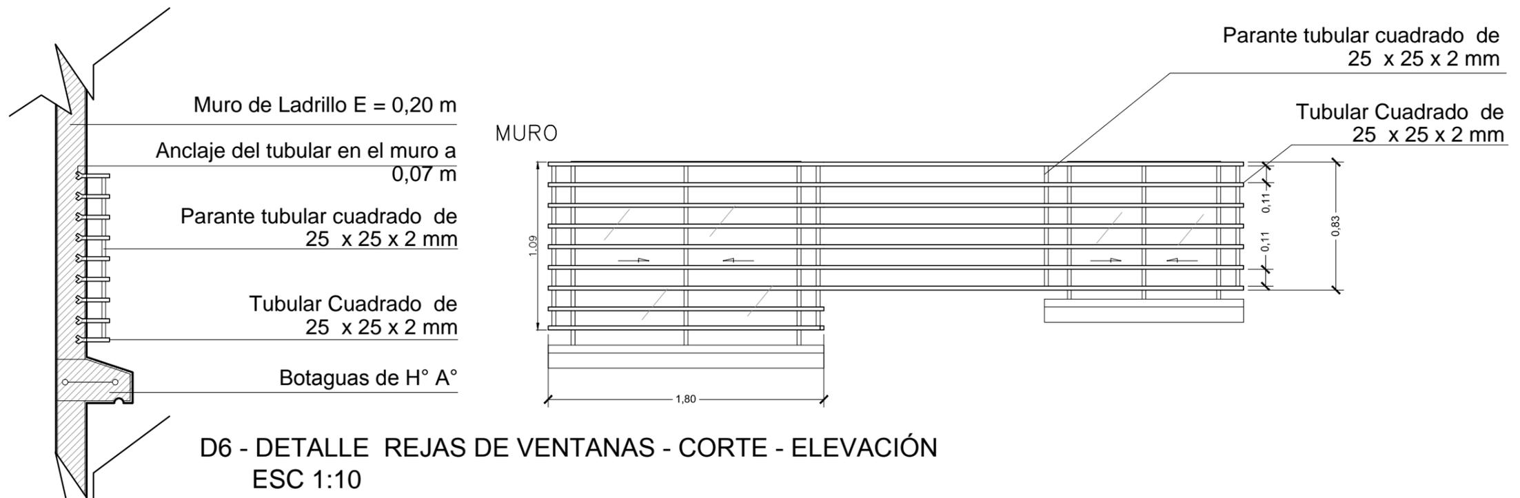
D6 - DETALLE REJAS DE VENTANAS - CORTE - ELEVACIÓN
