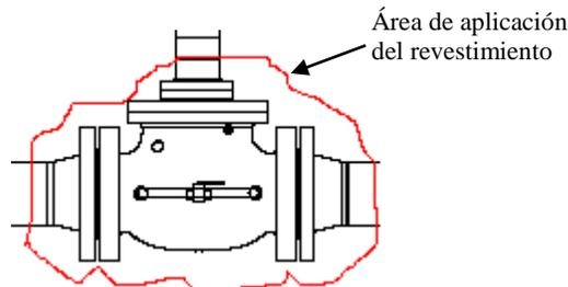
**Aplicación de Cinta.-** La aplicación de la cinta de cera se debe realizar de acuerdo con las recomendaciones del fabricante, y no deben existir defectos en su aplicación como dobleces o arrugas. El traslape de la cinta debe ser de al menos 1 plg en todas las aplicaciones. Para el trabajo en climas fríos se debe mantener la cinta de cera condiciones de temperatura adecuadas.
