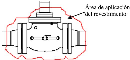
**Aplicación de Cinta.-** La aplicación de la cinta de cera se debe realizar de acuerdo con las recomendaciones del fabricante, y no deben existir defectos en su aplicación como dobleces o arrugas. El traslape de la cinta debe ser de al menos 1 plg en todas las aplicaciones. Para el trabajo en climas fríos se debe mantener la cinta de cera condiciones de temperatura adecuadas.
