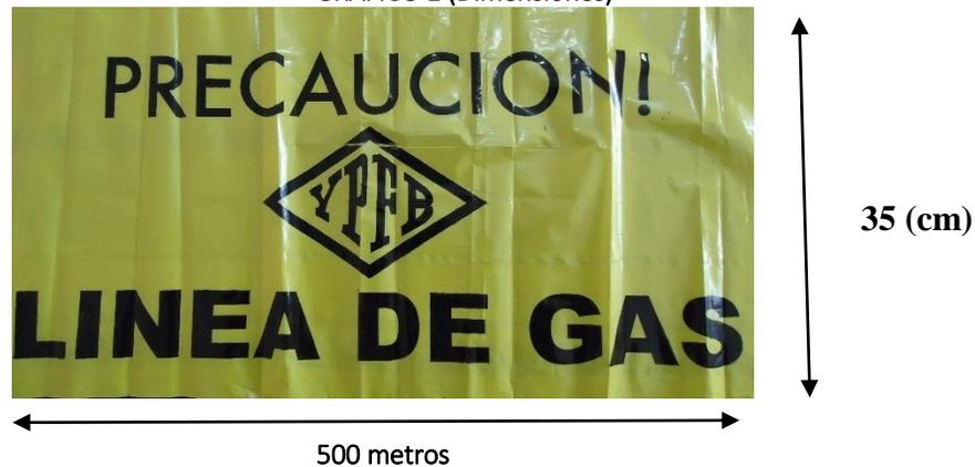
La cinta de señalización debe ser ubicada 30 cm sobre el nivel superior de la tubería, indicando “PRECAUCIÓN – LÍNEA DE GAS”
