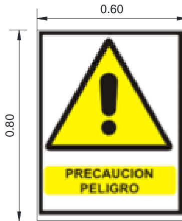
Figura 1. Señales de Advertencia
