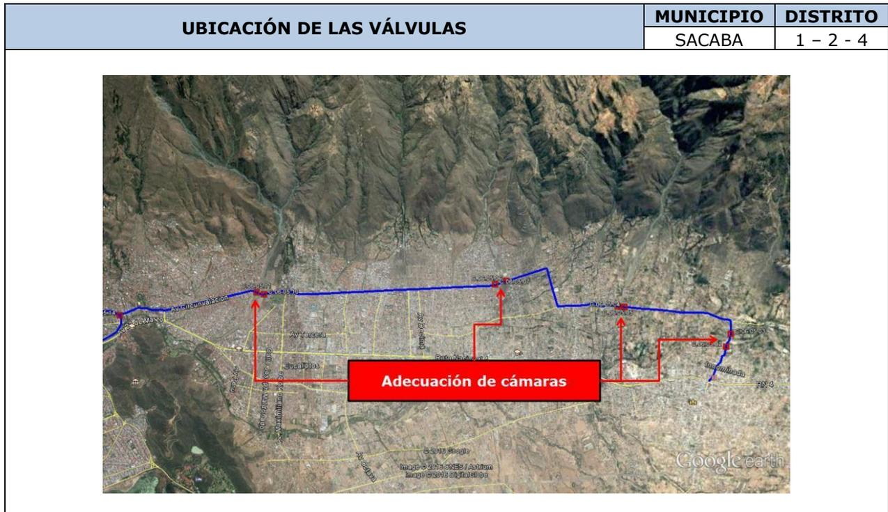
El Contratista deberá adecuar las cámaras de la Red Primaria Sacaba – Cercado para la instalación de válvulas de seguridad en su interior cuyas dimensiones se encuentran en la sección de gráficos.
