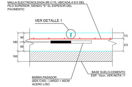
DETALLE JUNTA TRANSVERSAL DE CONTRACCION Escala 1:10 (MEDIDAS EN mm)
