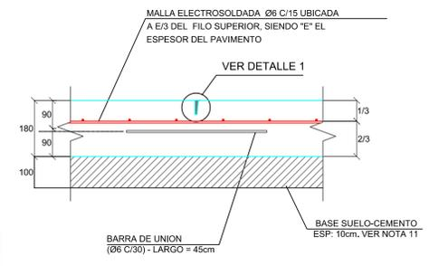
DETALLE JUNTA LONGITUDINAL DE ARTICULACION Escala 1:10 (MEDIDAS EN mm)
