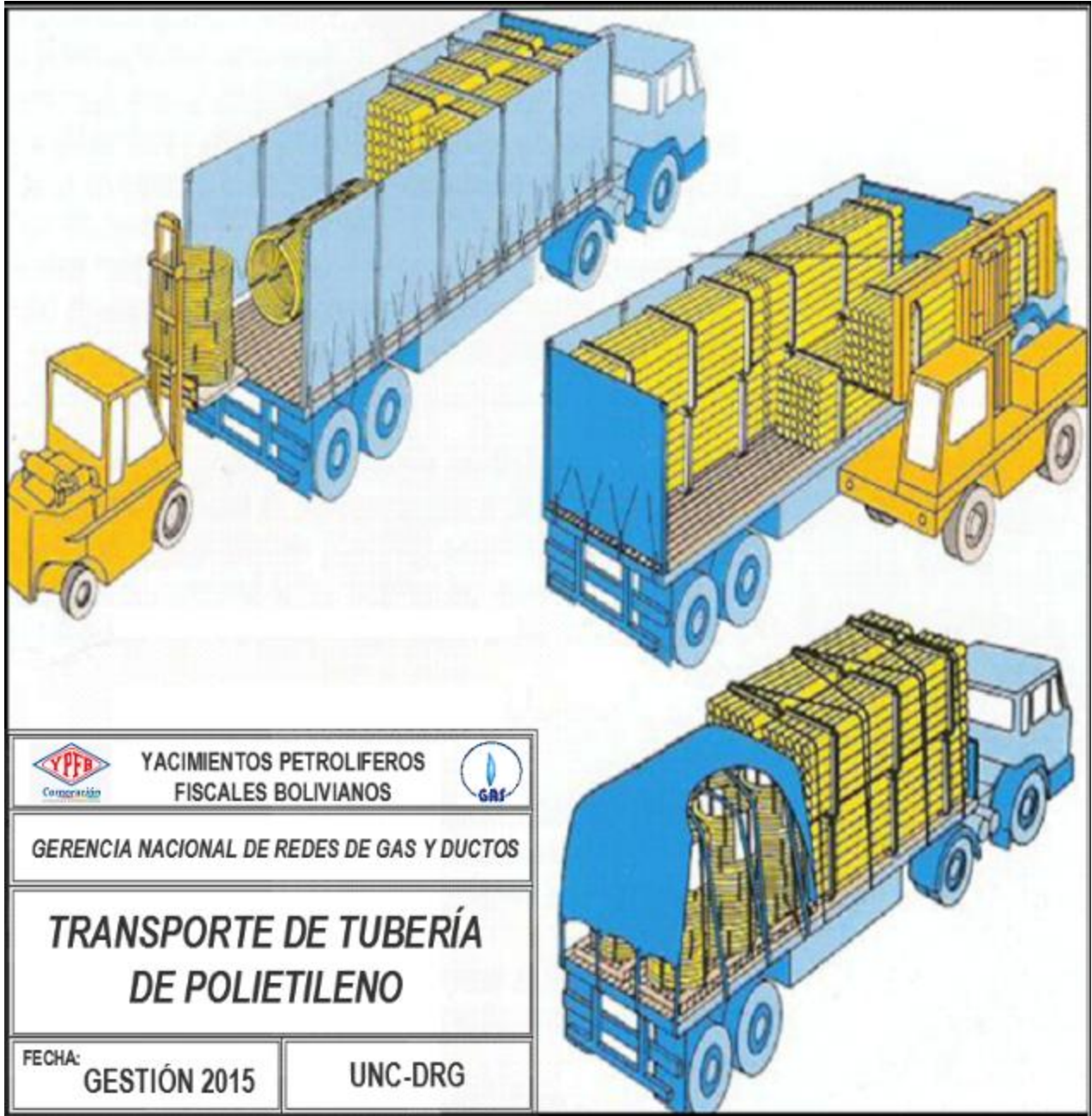
FIGURA 2. TRANSPORTE Y MANIPULACIÓN DE TUBERÍA DE POLIETILENO
