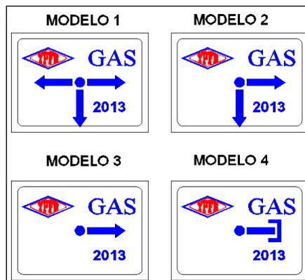
El espesor de las plaquetas de señalización deberá ser como mínimo de 0.9 centímetro, lo cual permitirá resistir las condiciones a las que puedan ser expuestas, debido a la ubicación de las mismas.
