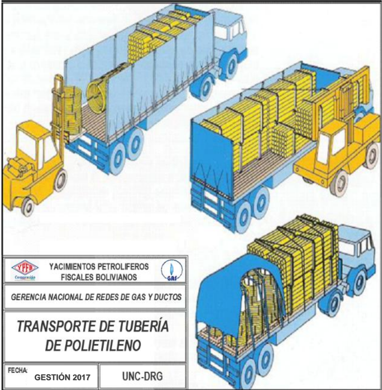
FIGURA 2. TRANSPORTE Y MANIPULACIÓN DE TUBERÍA DE POLIETILENO
