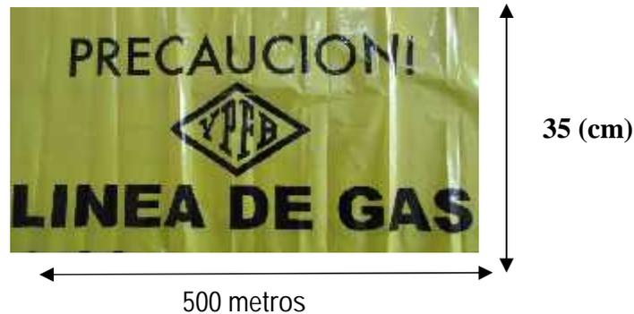
La cinta de señalización debe ser ubicada 40 cm antes del nivel superior de la zanja indicando "PRECAUCIÓN – LÍNEA DE GAS"
