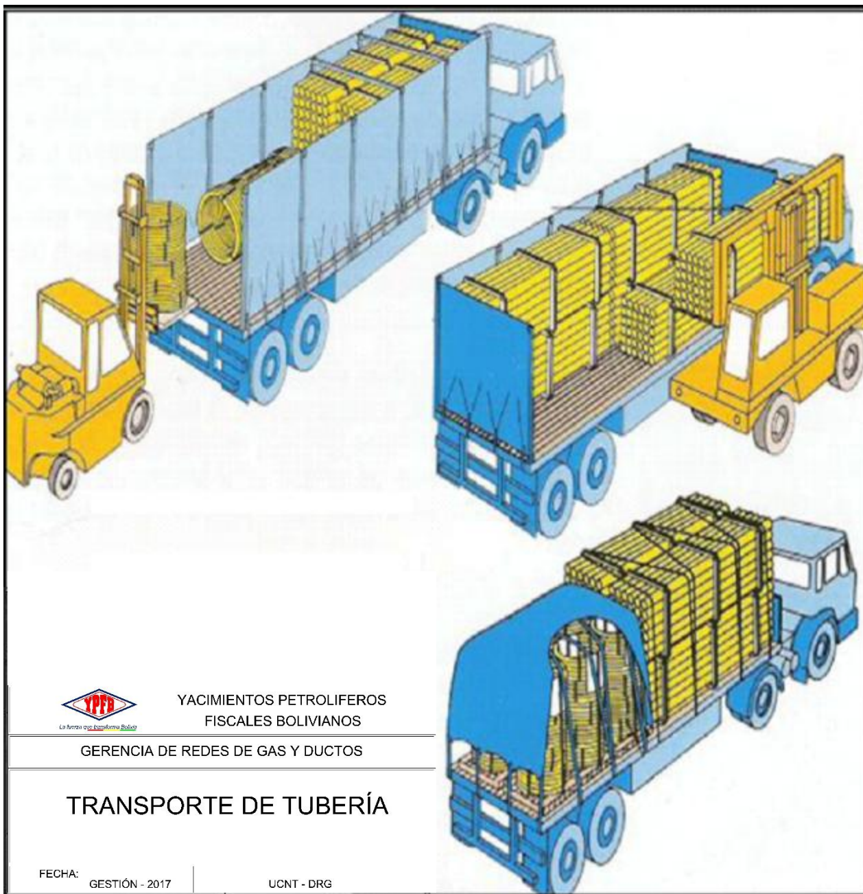
FIGURA 2. TRANSPORTE Y MANIPULACIÓN DE TUBERÍA DE POLIETILENO
