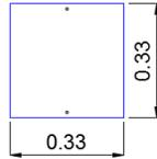
LOS LETREROS DEBEN SER DE PLANCHA DE 1/16", TRATADA CONTRA CORROSIÓN. CON 2 PERFORACIONES DE Ø 1/4". IMPRESION 3M
