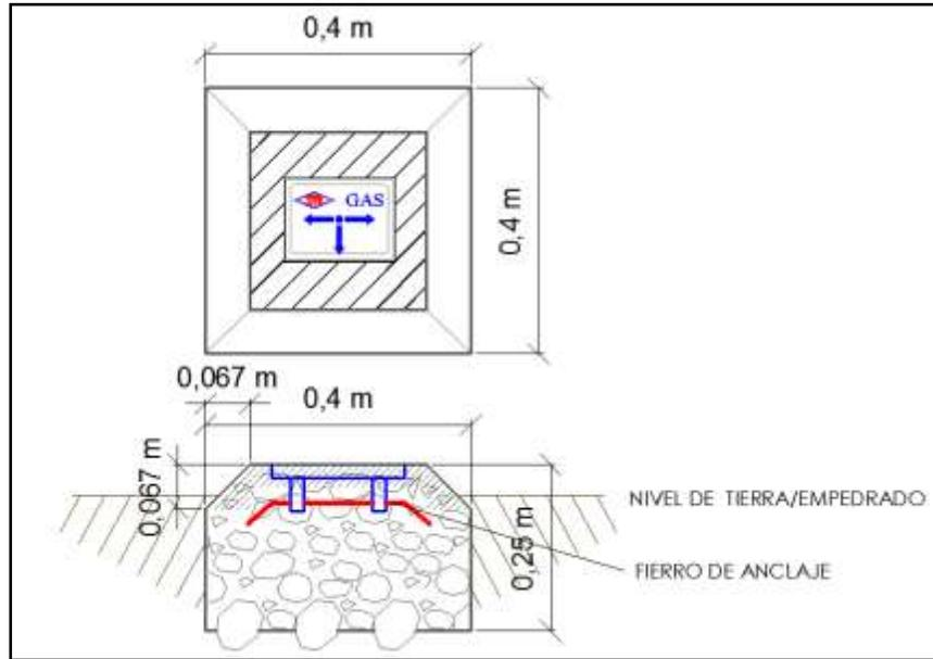
3.2 PLAQUETAS DE SEÑALIZACIÓN HORIZONTAL EN COBERTURAS DE ACERAS DE HORMIGÓN
