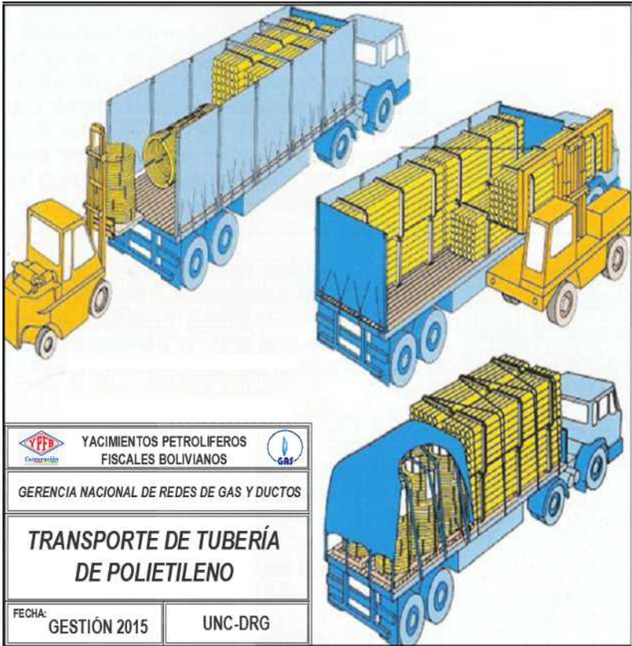
FIGURA 2. TRANSPORTE Y MANIPULACIÓN DE TUBERÍA DE POLIETILENO
