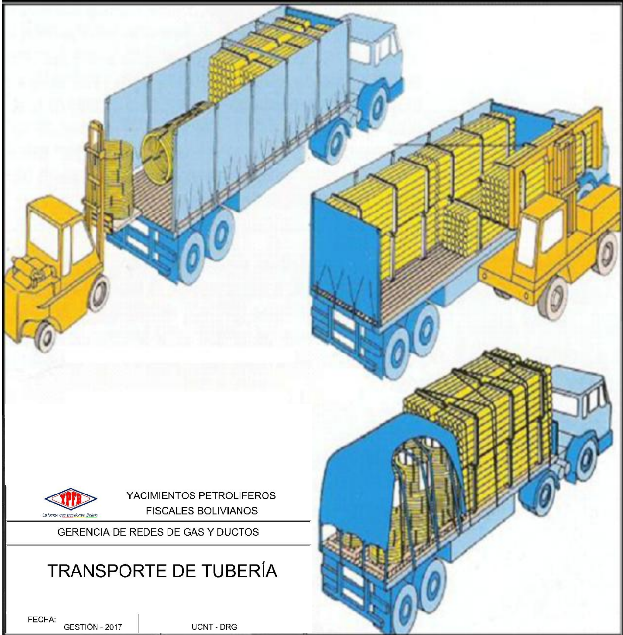
FIGURA 2. TRANSPORTE Y MANIPULACIÓN DE TUBERÍA DE POLIETILENO
