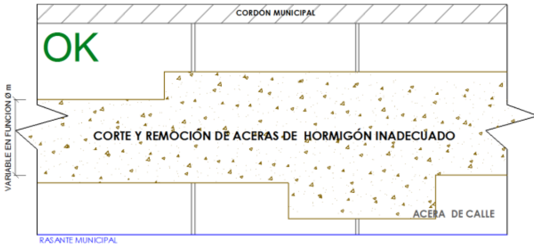
CORRECCIÓN DEL CORTE DE ACERA PARA SU FUTURA REPOSICIÓN
