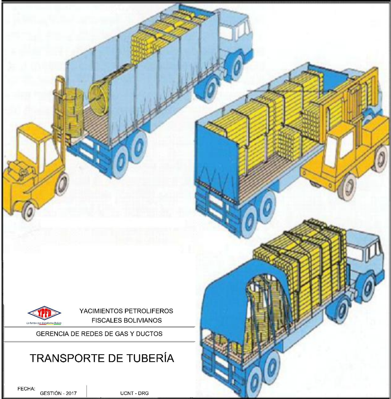
FIGURA 2. TRANSPORTE Y MANIPULACIÓN DE TUBERÍA DE POLIETILENO
