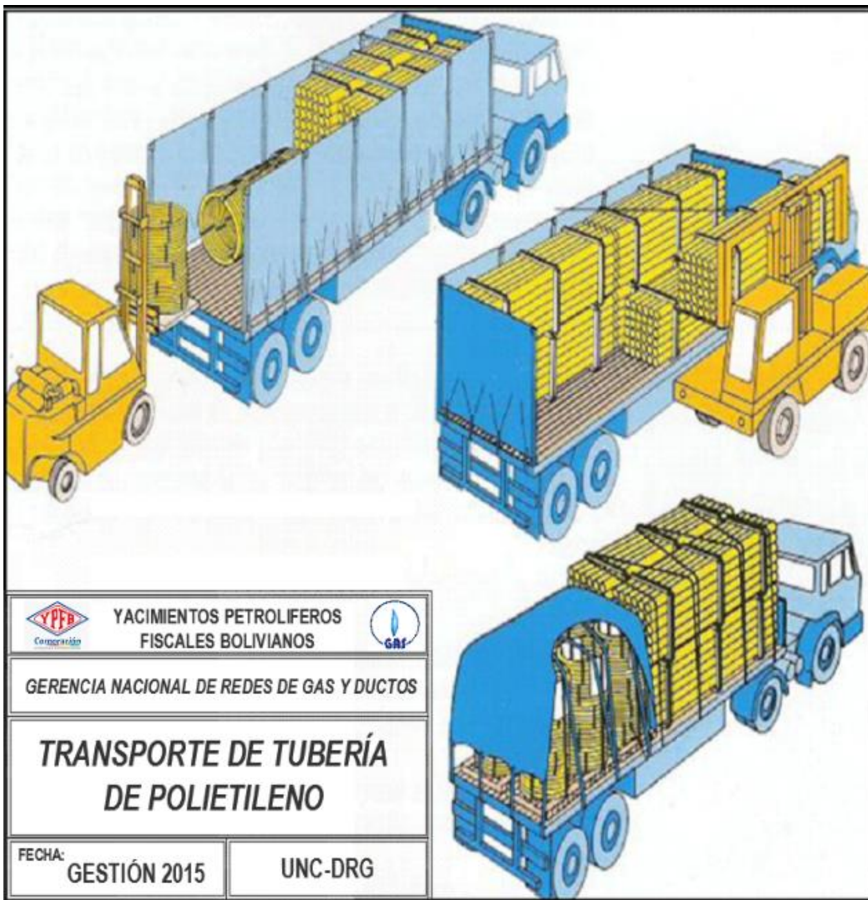
FIGURA 2. TRANSPORTE Y MANIPULACIÓN DE TUBERÍA DE POLIETILENO
