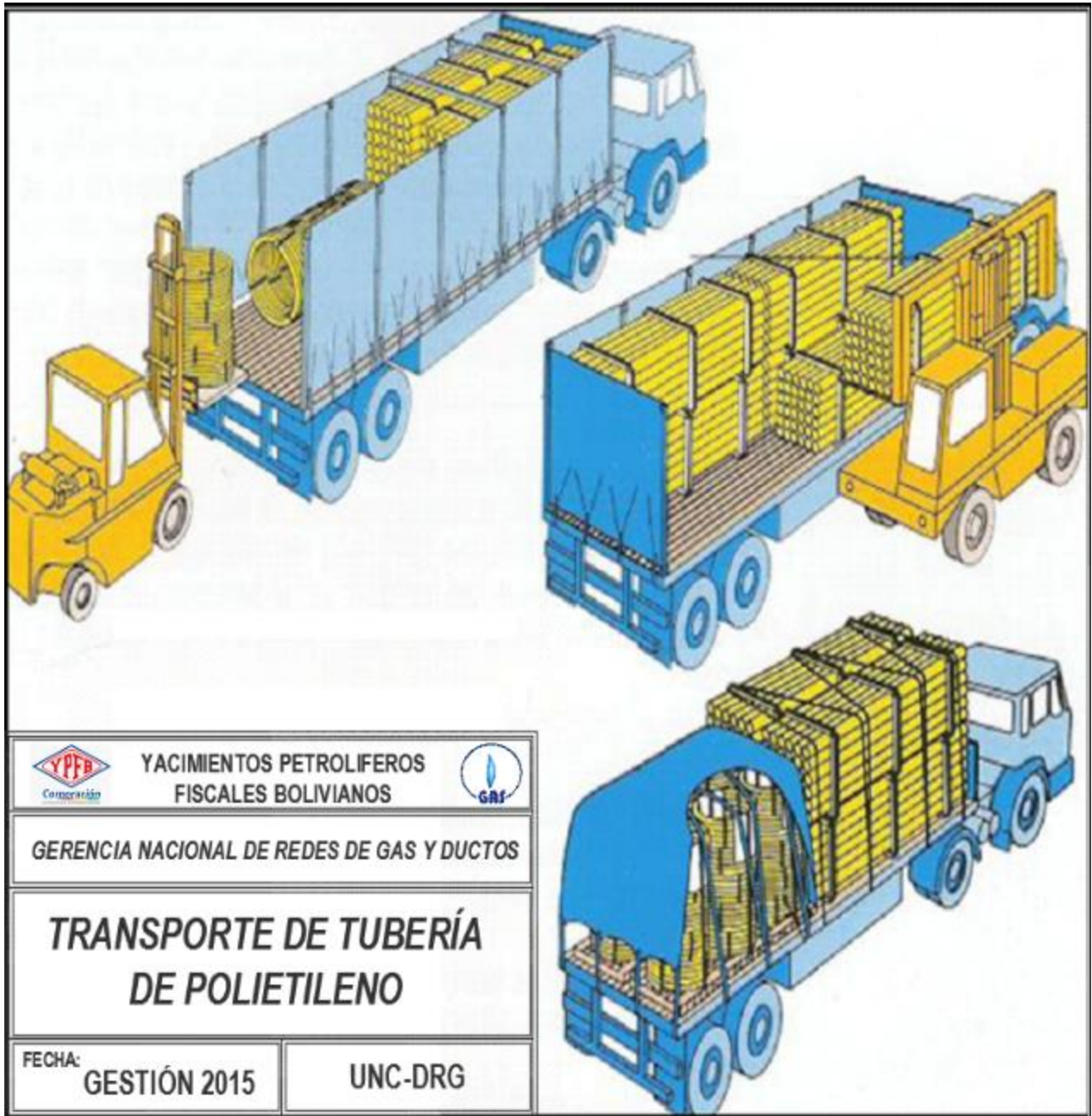
FIGURA 2. TRANSPORTE Y MANIPULACIÓN DE TUBERÍA DE POLIETILENO
