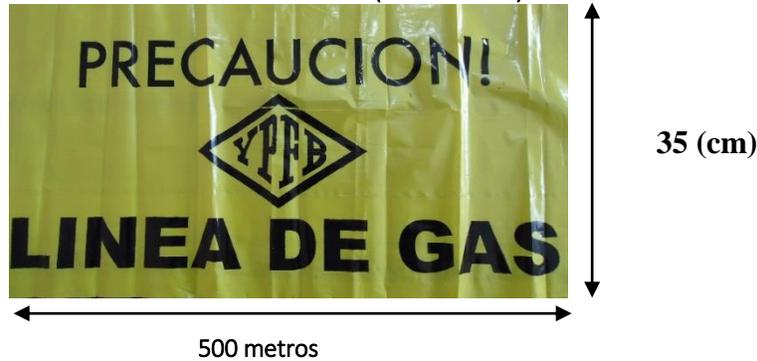
La cinta de señalización debe ser ubicada 30 cm por debajo del nivel del suelo, sobre una superficie compactada y plana y la misma quedará centrada con respecto al eje longitudinal de la zanja, la cinta deberá indicar "PRECAUCIÓN – LÍNEA DE GAS"
