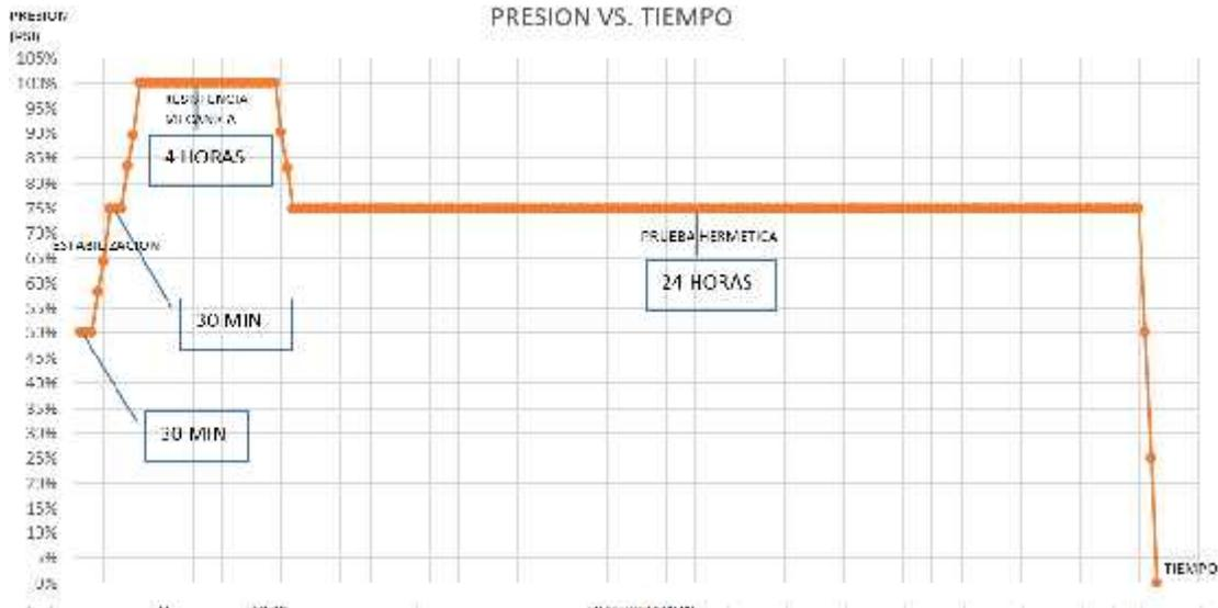
Si cualquiera de las presiones registrara disminuciones que superen las admitidas por las variaciones de las temperaturas, se localizará visualmente la zona en que se produce la pérdida, por la aparición de humedad o baño sobre la superficie.
