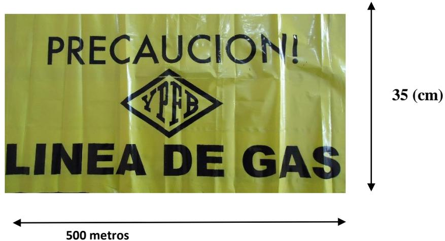
La cinta de señalización debe ser ubicada 30 cm antes del nivel superior de la zanja indicando “PRECAUCIÓN – LÍNEA DE GAS”
