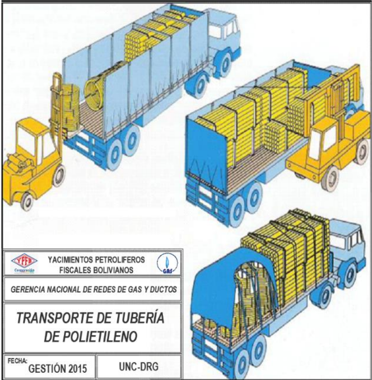
FIGURA 2. TRANSPORTE Y MANIPULACIÓN DE TUBERÍA DE POLIETILENO
