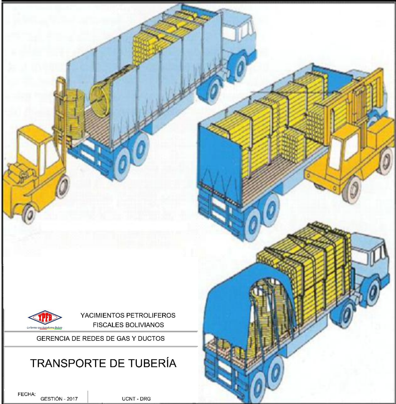
FIGURA 2. TRANSPORTE Y MANIPULACIÓN DE TUBERÍA DE POLIETILENO
