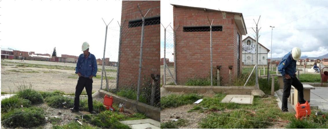
**3.- MEDICIÓN DE LA RESISTENCIA DEL SUELO**
