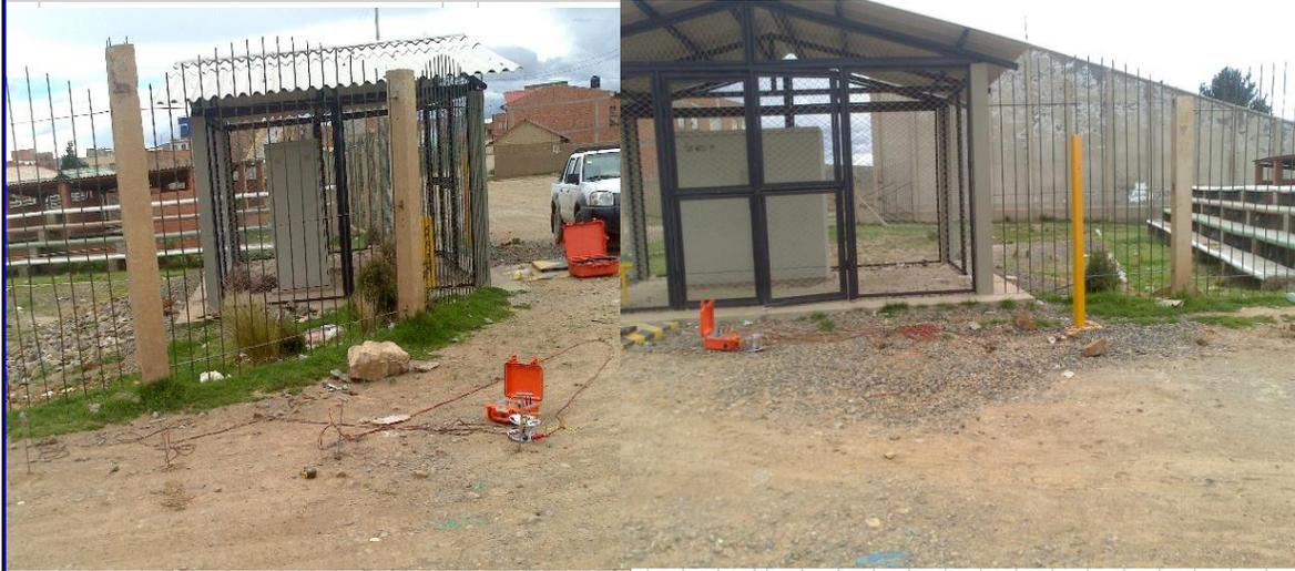
**3.- MEDICIÓN DE LA RESISTENCIA DEL SUELO**
