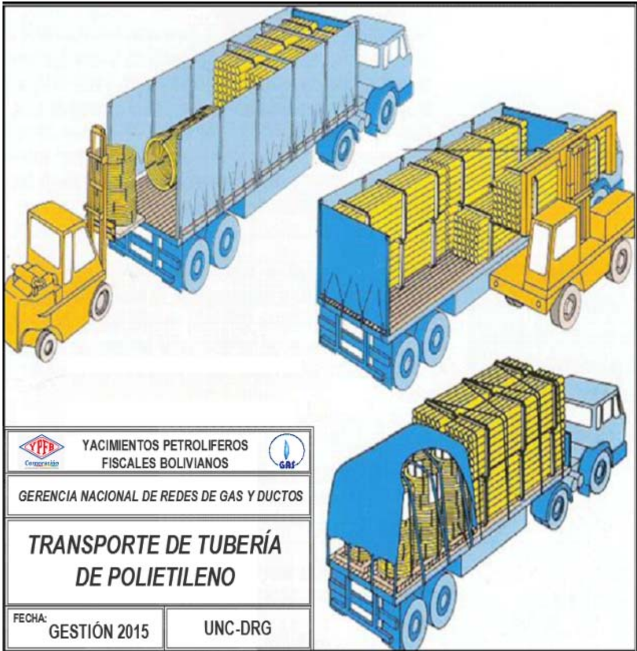
FIGURA 2. TRANSPORTE Y MANIPULACIÓN DE TUBERÍA DE POLIETILENO
