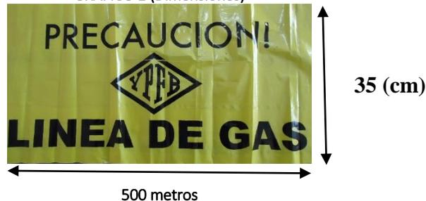
La cinta de señalización debe ser ubicada 40 cm antes del nivel superior de la zanja indicando "PRECAUCIÓN – LÍNEA DE GAS"
