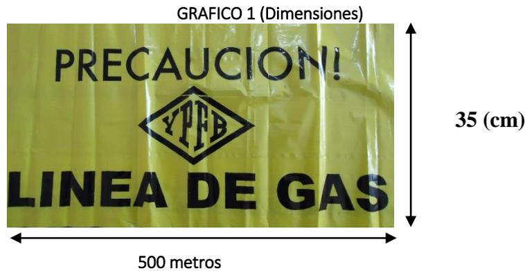
La cinta de señalización debe ser ubicada 30 cm por debajo del nivel del suelo, sobre una superficie compactada y plana y la misma quedará centrada con respecto al eje longitudinal de la zanja, la cinta deberá indicar "PRECAUCIÓN – LÍNEA DE GAS"
