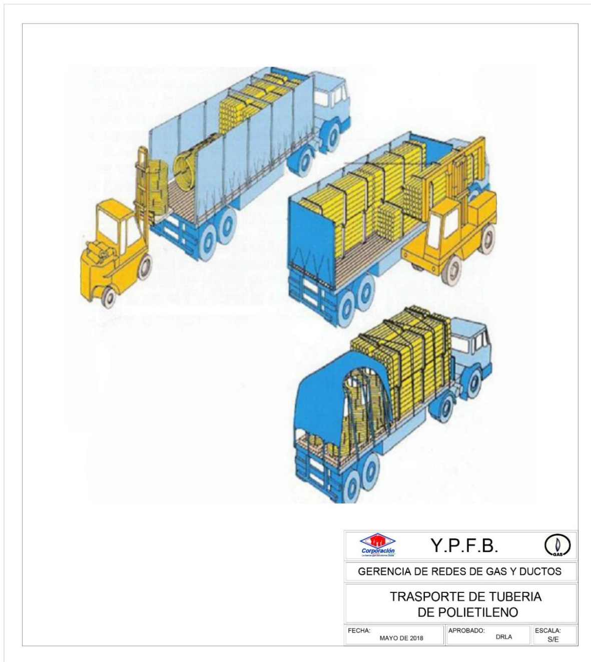
FIGURA 2. TRANSPORTE Y MANIPULACIÓN DE TUBERÍA DE POLIETILENO
