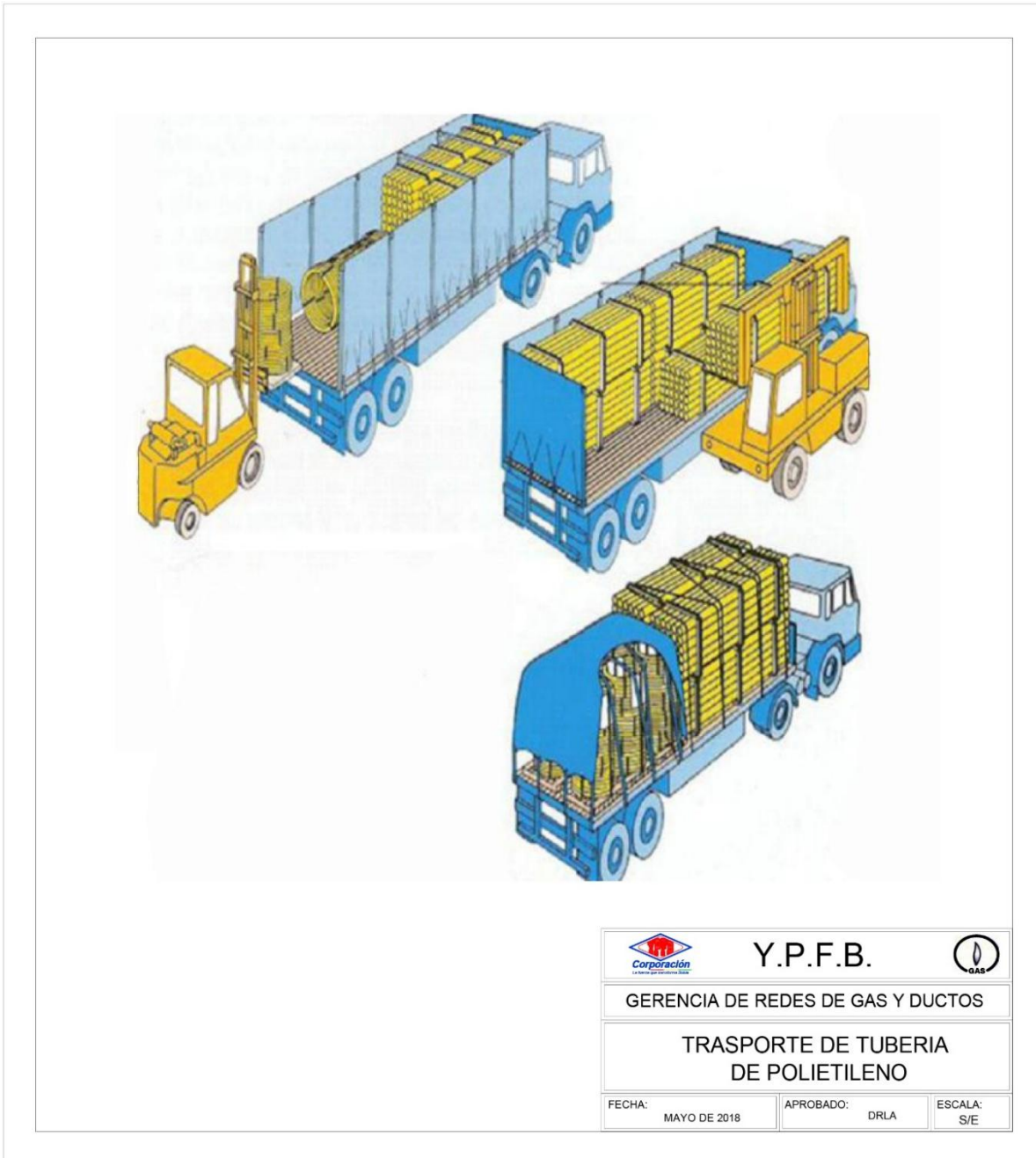
FIGURA 2. TRANSPORTE Y MANIPULACIÓN DE TUBERÍA DE POLIETILENO
