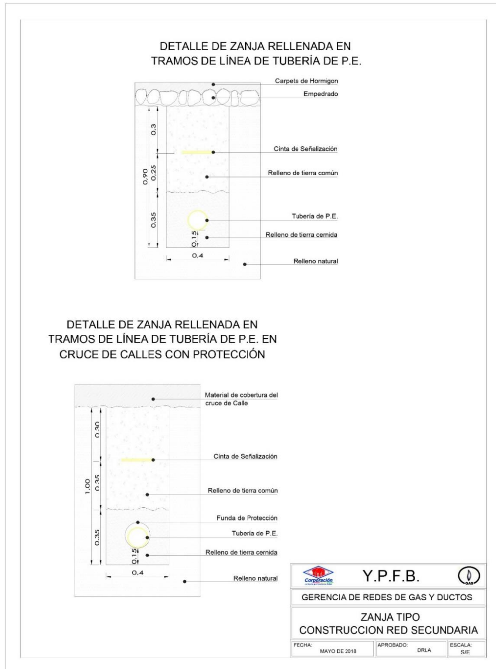
FIGURA 3. ZANJA TIPO CONSTRUCCIÓN RED SECUNDARIA
