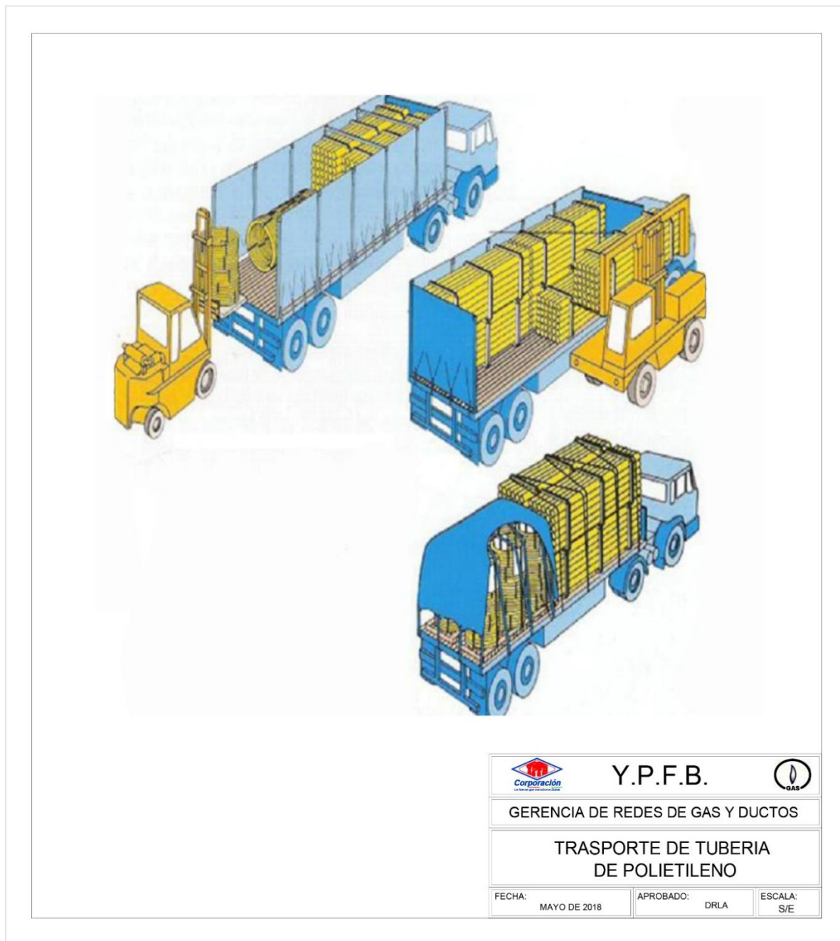
FIGURA 2. TRANSPORTE Y MANIPULACIÓN DE TUBERÍA DE POLIETILENO
