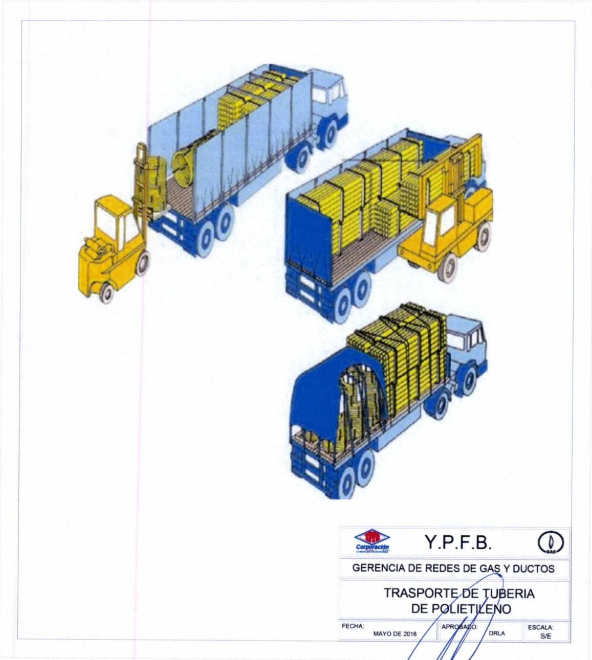
FIGURA 2. TRANSPORTE Y MANIPULACIÓN DE TUBERÍA DE POLIETILENO
