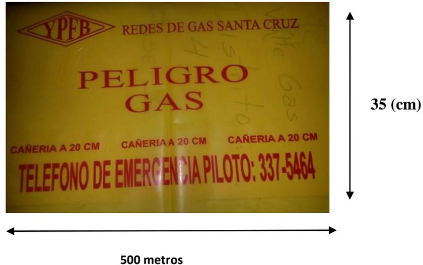
La cinta de señalización debe ser ubicada 30 cm antes del nivel superior de la zanja indicando “PRECAUCIÓN – LÍNEA DE GAS”
