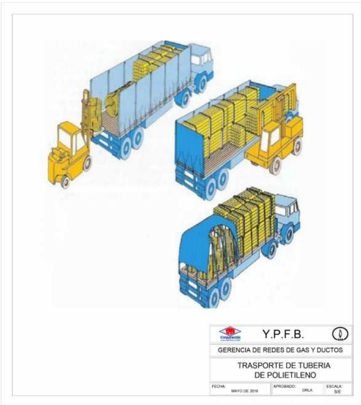
FIGURA 2. TRANSPORTE Y MANIPULACIÓN DE TUBERÍA DE POLIETILENO
