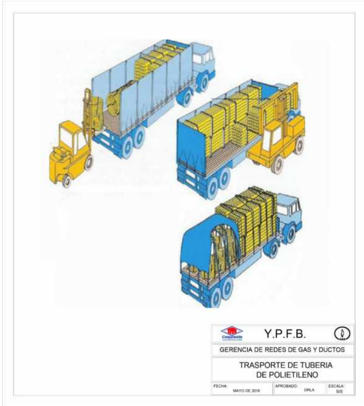
FIGURA 2. TRANSPORTE Y MANIPULACIÓN DE TUBERÍA DE POLIETILENO
