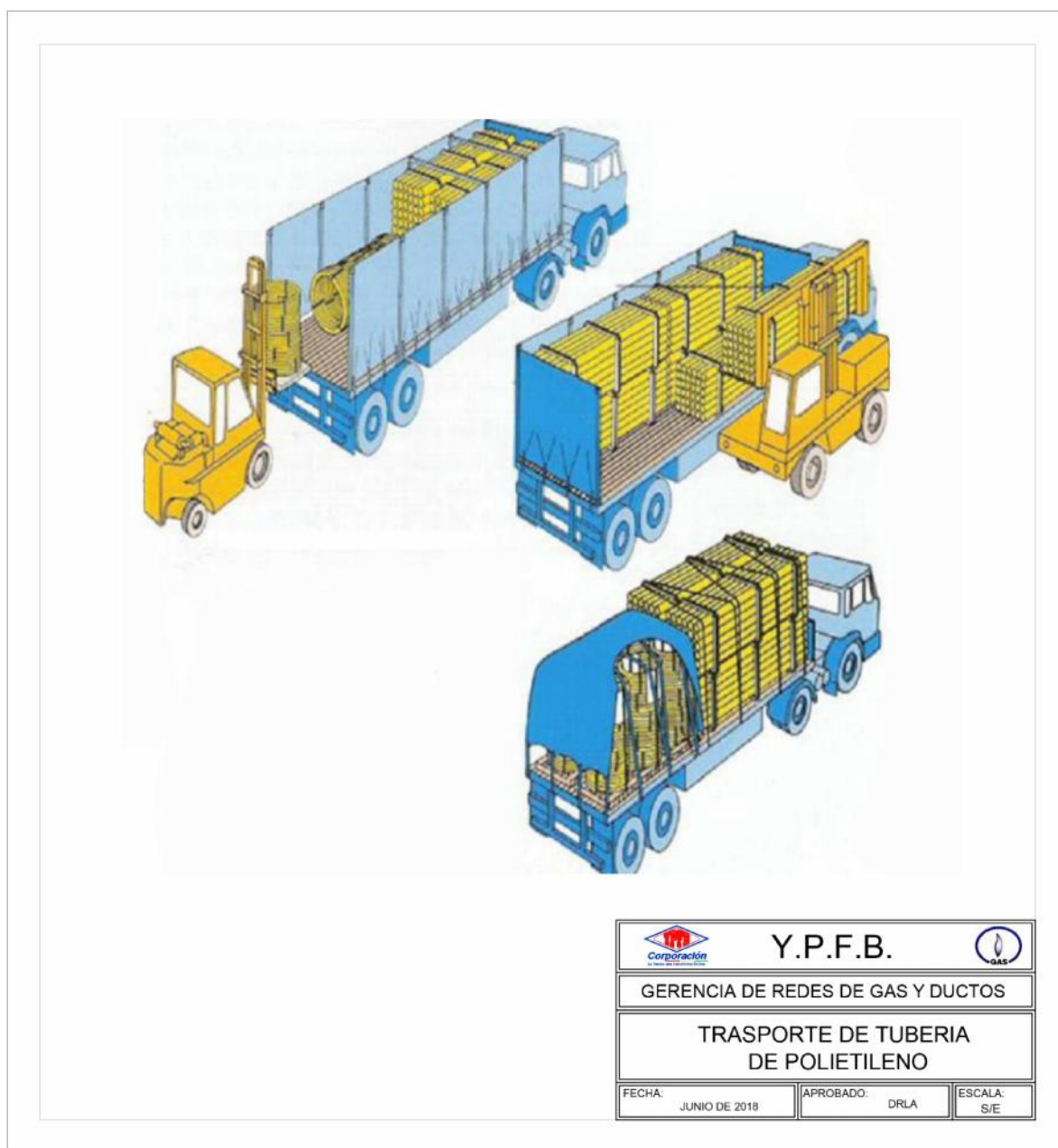
FIGURA 2. TRANSPORTE Y MANIPULACIÓN DE TUBERÍA DE POLIETILENO
