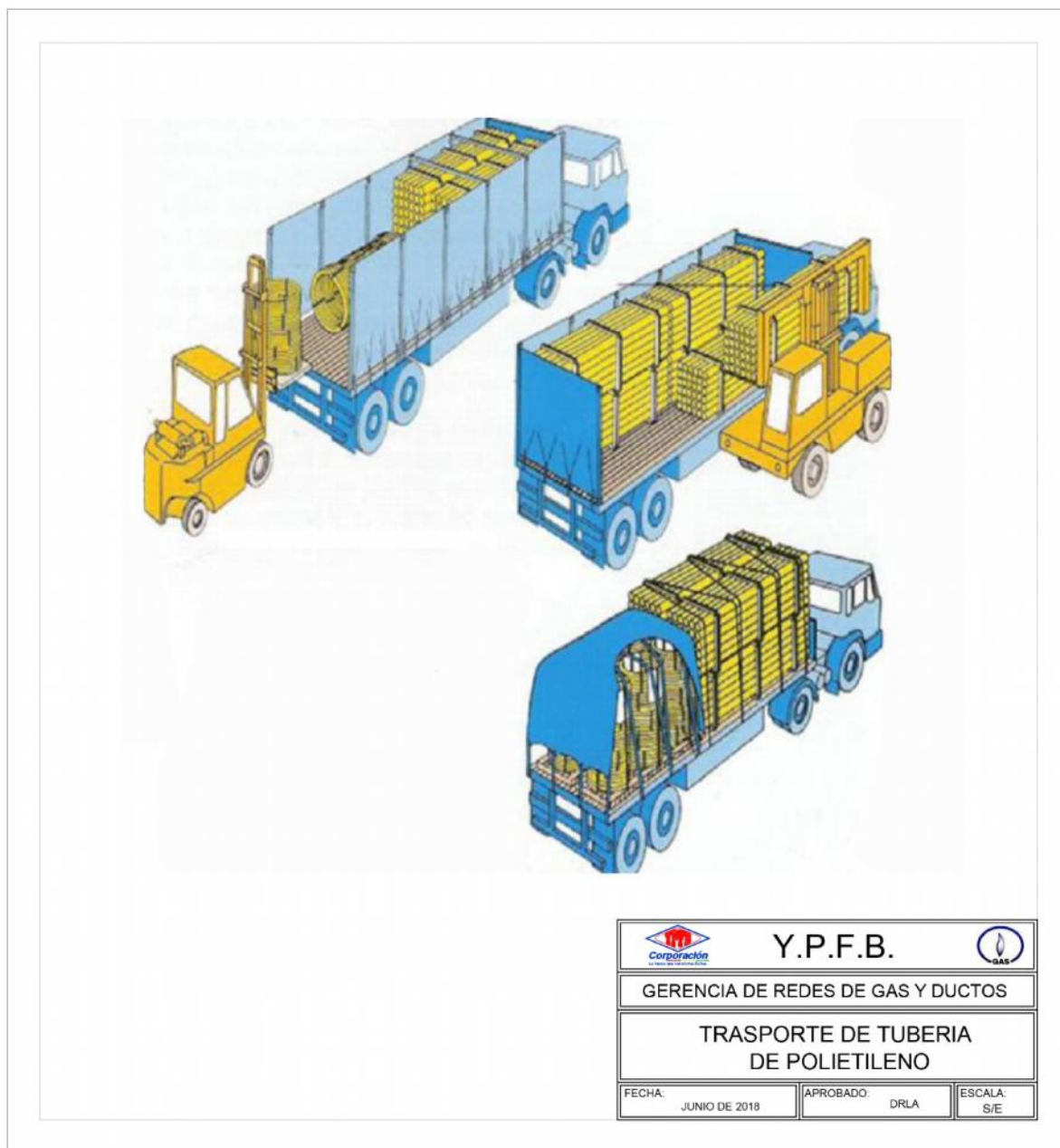
FIGURA 2. TRANSPORTE Y MANIPULACIÓN DE TUBERÍA DE POLIETILENO
