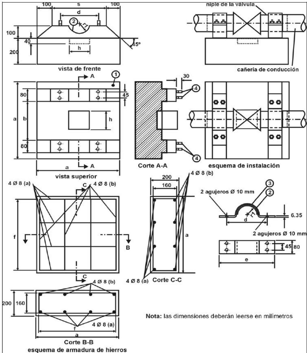
**Nota:** Las dimensiones de la base de fijación podrán ser ajustadas de acuerdo al tipo de válvula y según aprobación del supervisor de obra.
